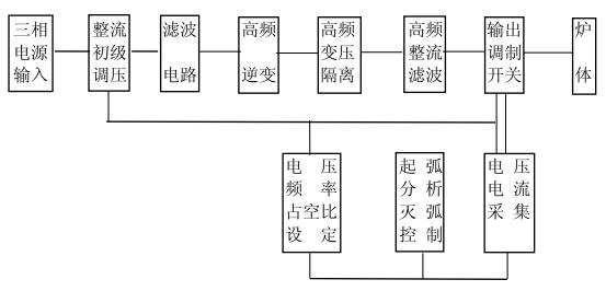
输入三相电源经整流及初步调压后由滤波电路调整为直流电压,再经高频逆变回路转化为高频振荡,经高频变压器隔离变压后再由高频整流滤波环节得到所需幅值,最后根据设定的输出波形参数,由输出调制开关将直流电压转化为所需要的脉冲波形。当脉冲送至炉体内时,电路会随时检测脉冲电压及电流参数,及时调整电压,确保电压稳定,并可在 0.5 微秒内发现异常起弧放电特征,并发出关断信号,主回路可在 3 微秒内切断输出电流而达到保护工件不受损伤的目的。
